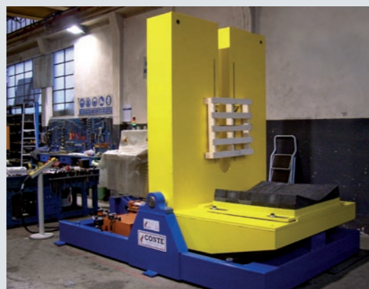
Ribaltatore per coils mod. 105 + sistema ferma pallet Coils tilter + pallet stop system mod. 105
