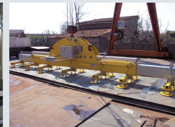
Attrezzatura con ventuno ventose per lamiera Vacuum sheet lifters with twentyone holdfasts
