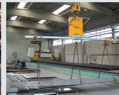
Attrezzatura con ventose e ganci di sollevamento Vacuum sheet lifters with holdfasts and lifting hooks
