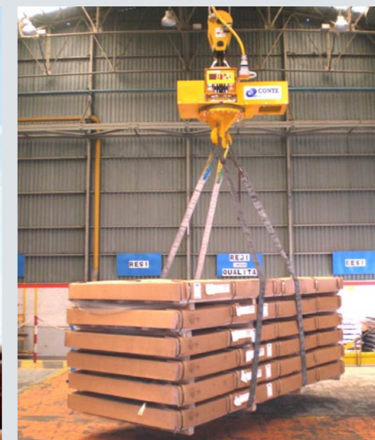
Rotazione motorizzata mod. 1522 con pesatura Motorized rotation mod. 1522 with weighting system
