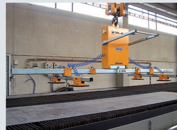
Attrezzatura con quattro ventose per lamiera Vacuum sheet lifters with four holdfasts
