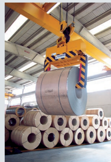
Pinza per coils mod. 304 + sistema di pesatura Grab mod. 304 + weighing device
