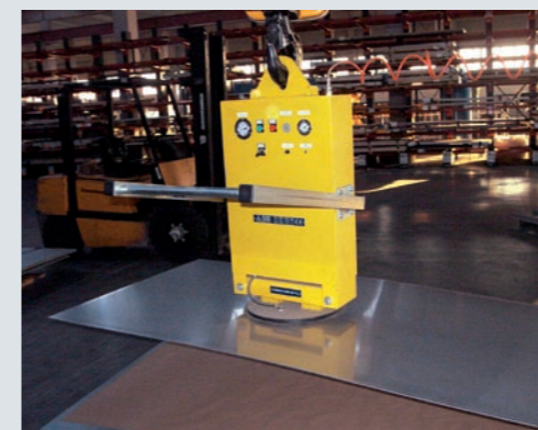
Attrezzatura con una ventosa per lamiera Vacuum sheet lifters with one holdfast
