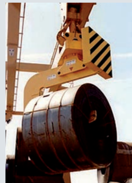
Rotazione motorizzata + gancio a "C" mod. 500 +1552 Motorized rotation + "C" hook mod. 500 +1552
